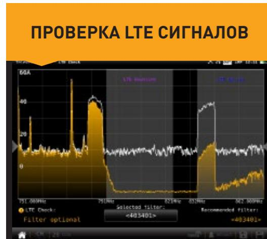
Позволяет проанализировать влияние LTE сигнала на каналы DTT и определить есть ли необходимость использования фильтров. Также позволяет имитировать спектр в результате установки LTE фильтра, предложенного самим измерителем. Пользователю предоставляется возможность выбора наиболее подходящего для установки фильтра из имеющегося списка.
