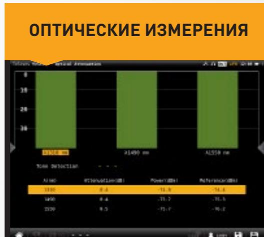
Измеритель имеет оптический вход (широкополосный или избирательный), дающий возможность измерять оптическую мощность или аттенюацию на трех длинах волн [1310 nm, 1490 nm и 1550 nm], а также возможность анализа RFoG установок.
